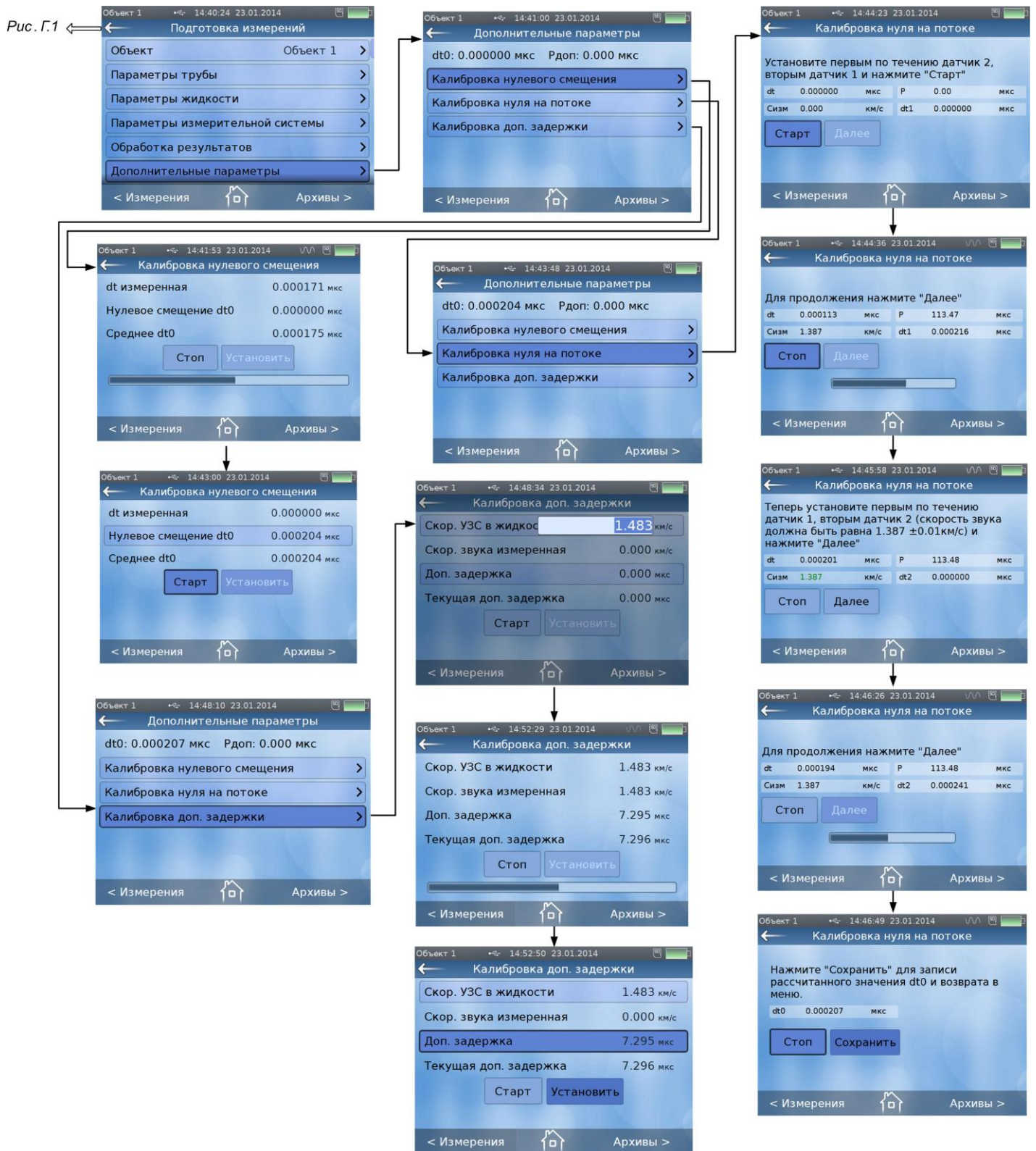
Рис.Г.5. Меню «Подготовка измерений» / «Дополнительные параметры»
