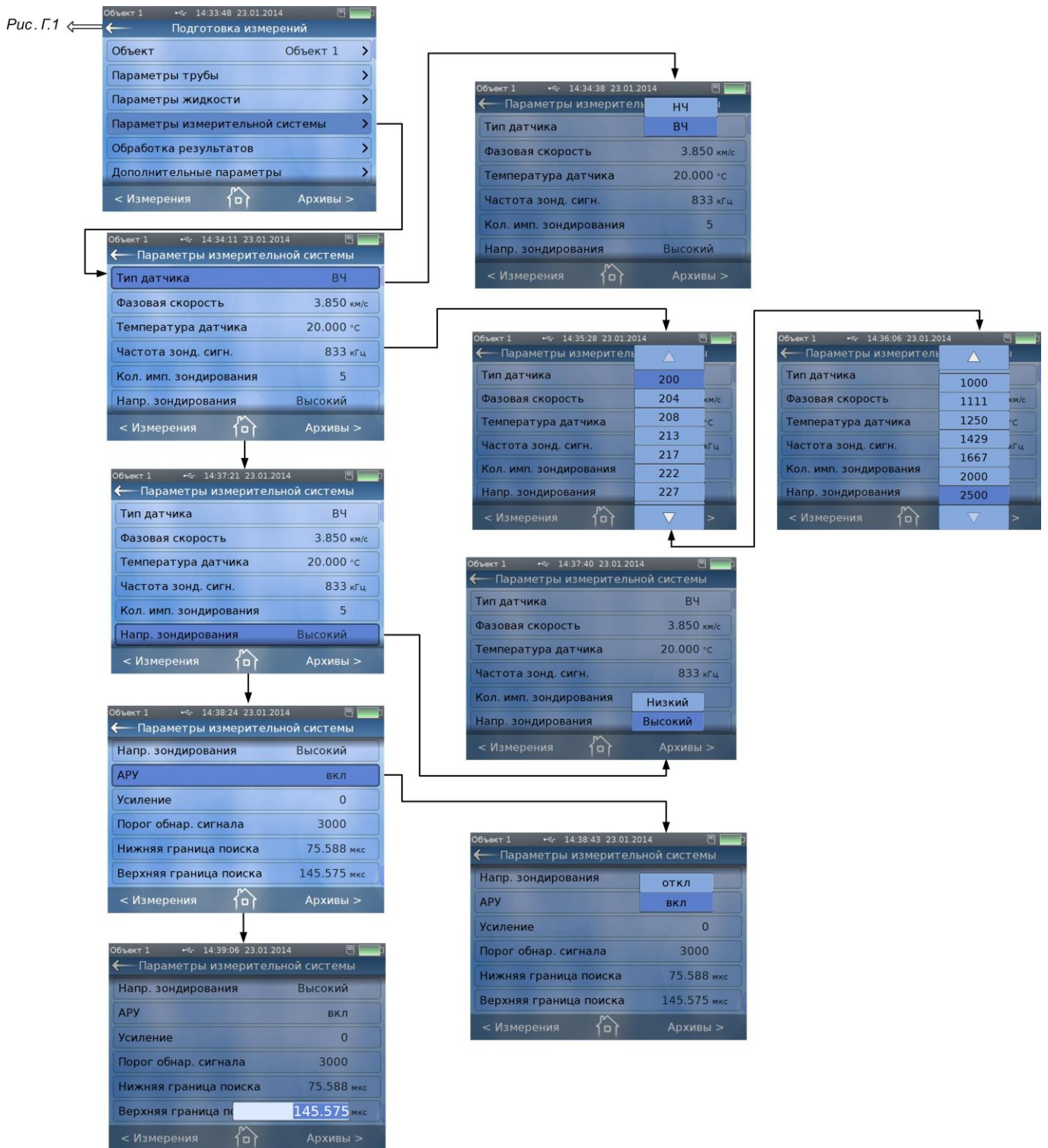
Рис.Г.4. Меню «Подготовка измерений» / «Параметры измерительной системы»
